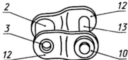
д - другие типы разборных соединительных звеньев (замки могут быть различной конструкции и на чертеже показано только их расположение)
